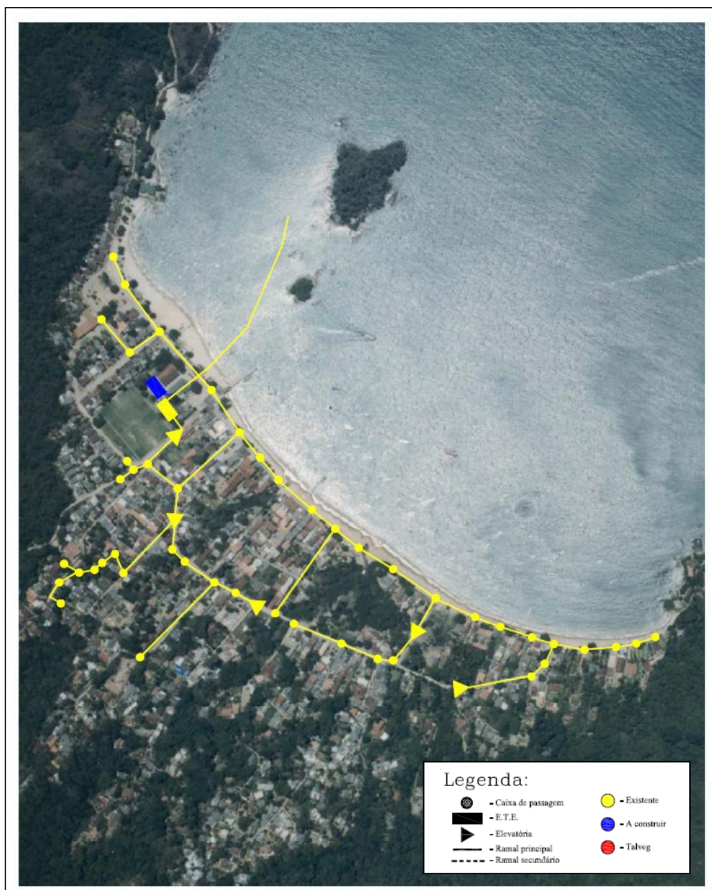
Figura 6.1-XI: Rede Coleta de Esgoto, elevatórias, ETE e emissário de lançamento de efluentes no mar da Vila do Abraão (Fonte SAAE/AR - 2012)
