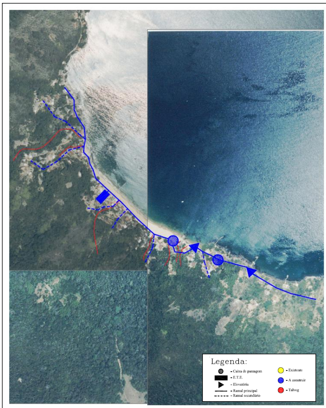
Figura 6.1-XV: Rede Coleta de Esgoto existente (inacabada) e ampliações sugeridas para ETE com destino final no córrego Vianna (Fonte SAAE/AR - 2012)
